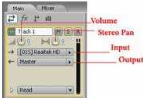
شکل ۱۰-۱۱ کنترل‌های ورودی و خروجی
